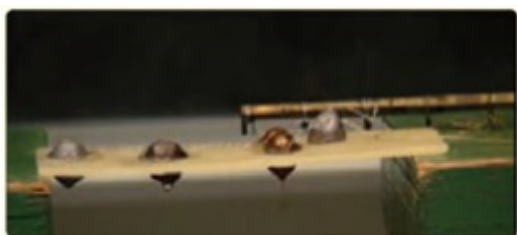
گوی‌ها بسته به جنس خود، ورقه‌ی پارافین را در زمان‌های متفاوت ذوب می‌کنند.
